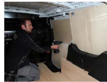
Placez et vissez la porte latérale Partie haute 6 vis 4x25
