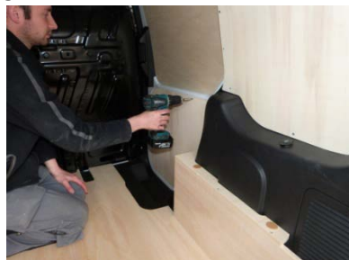
Placez et vissez la porte latérale Partie basse 5 vis 4x25
