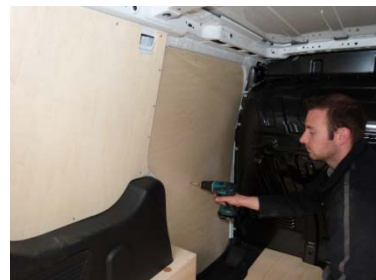
Placez & vissez le côté Av Gauche 7 vis 4x25
