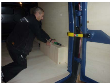
Placez et vissez le passage de roue Droit 6 vis 4x30
