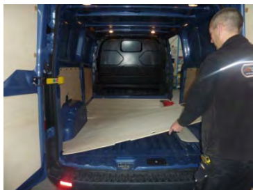
Placez & vissez le Plancher 15 vis 4x25
