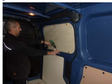
Placez et vissez la porte latérale Partie haute 6 vis 4x25
