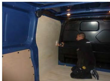
Placez & vissez le côté Av Gauche 8 vis 4x25
