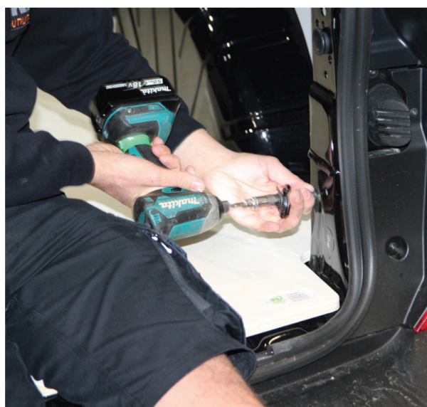
Remettre en place les anneaux d'arrimage
