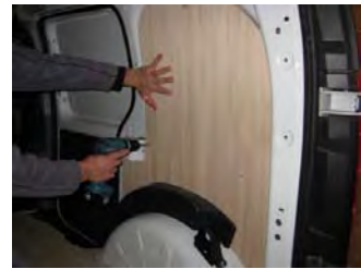
Enlever le cric de levage, puis Placez & vissez le côté AR Droit 9 vis 4x25
