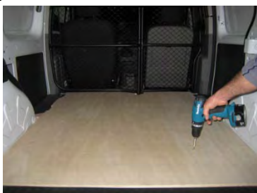
Placez et vissez le plancher 4 vis 4x25
