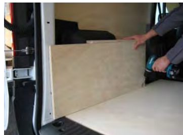
Placez et vissez le passage de roue Gauche 5 vis 4x30
