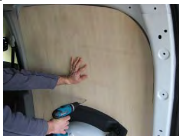
Enlever le cric de levage, puis Placez & vissez le côté Droit 7 vis 4x25
