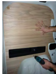
Placez & vissez le côté AR Gauche 7 vis 4x25
