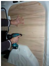
Placez et vissez le côté AR Droit 7 vis 4x25
