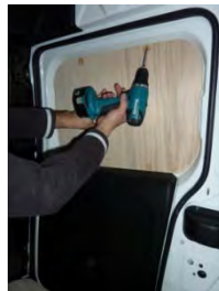
Placez et vissez la porte latérale Partie haute 4 vis 4x25
