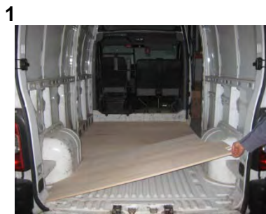
1 Placez & vissez le Plancher 24 vis 4x25
