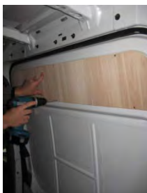
Placez & vissez la partie haute de La porte latérale 6 vis 4x25
