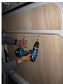
Placez & vissez la partie centrale De la porte latérale 4 vis 4x25
