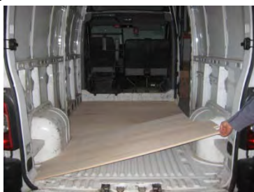
Placez & vissez le Plancher 24 vis 4x25
