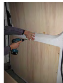
Placez & vissez la partie basse de la Porte latérale 12 vis 4x25
