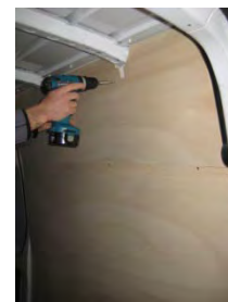
Placez & vissez la partie haute côté Droit 12 vis 4x25
