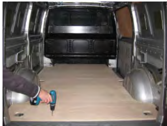
Placez & vissez le Plancher AR 6 vis 4x25
