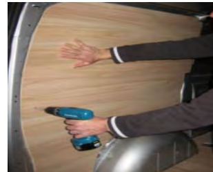
Placez & vissez le côté AR Gauche 10 vis 4x25
