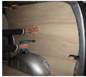
Placez et vissez le côté AR Droit 8 vis 4x25
