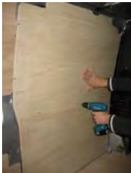
Placez & vissez le côté AV Gauche 7 vis 4x25
